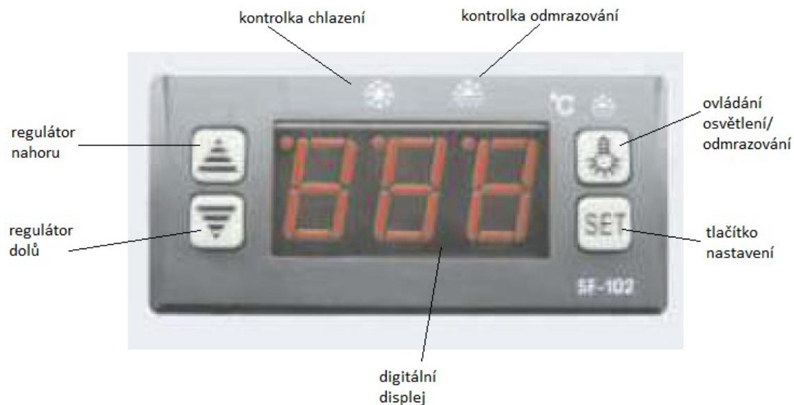
Jedná se o integrovaný regulátor minimálních rozměrů.
